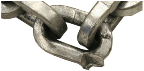
De kettingschakel is mechanisch beschadigd.
