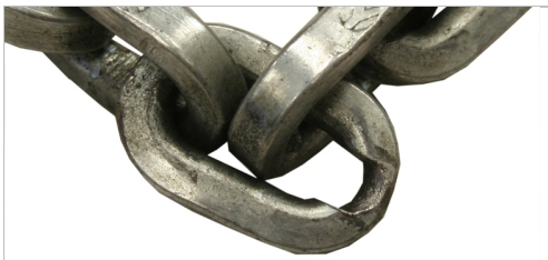
De kettingschakel is sterk versleten.
